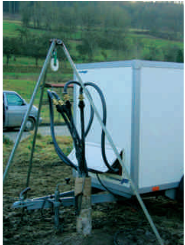
Abb. 4 Aufbau eines Thermal Response Tests
